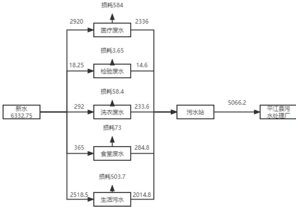
图 2-1 水平衡图 单位 m³/a
