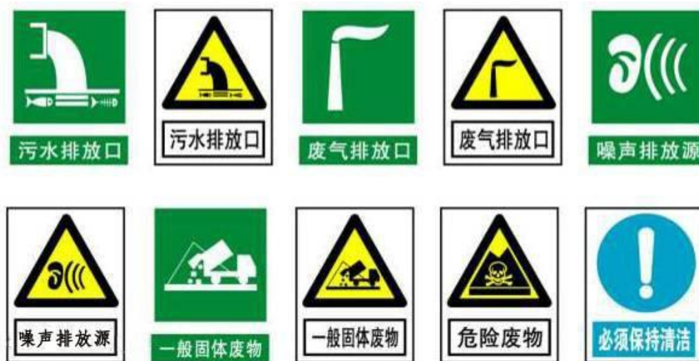
图 11.2-1 废气、废水、噪声排放口环境保护图形标志牌
