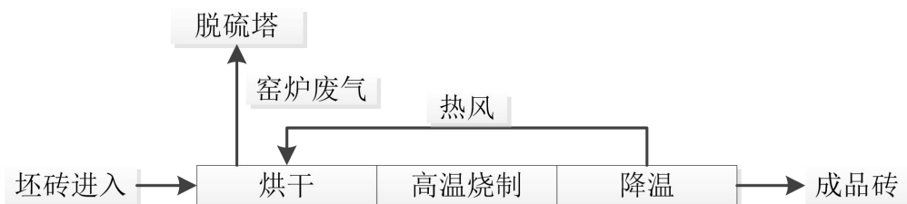
图 2-3 页岩烧结砖生产工艺流程及产污节点
